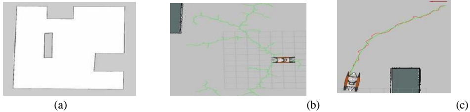
Şekil 1: (a) Grid harita (b) RRT (c) RRT ve Bezier Eğrisi ile oluşturulan yol
